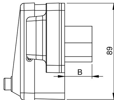
B: Cota según el espesor de la puerta.
