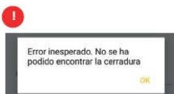
Si se muestra este mensaje durante la utilización de la App volver a intentar la apertura aproximándose a la puerta, puede estar fuera del alcance del módulo (max. 10Mts. sin obstáculos). Verificar que el está activado el Bluetooth en el teléfono. Verificar que el módulo tiene alimentación.
